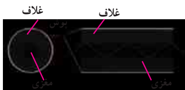
الف) طرحی از ساختار یک تار نوری و مسیر زیگزاگی که نور در آن می‌بیماید.
