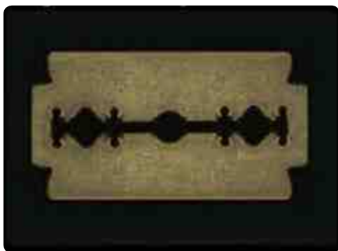
شکل ۴-۲۷ پراش نوری تکفام که از لبه‌های تیز درون و بیرون یک تیغ ایجاد شده است.
