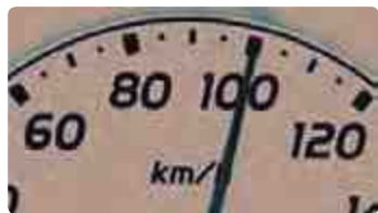
شکل ۱-۶ عقربه تندی سنج، تندی لحظه‌ای خودرو را نشان می‌دهد و هیچ گونه اطلاعی در خصوص جهت حرکت خودرو به ما گزارش نمی‌کند.
