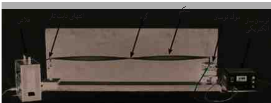
شکل ۴-۳۶ اسباب آزمایشی برای ایجاد موج ایستاده در تار کشیده. توجه کنید سری که به مولد نوسان متصل است، تقریباً در محل گره واقع است.
