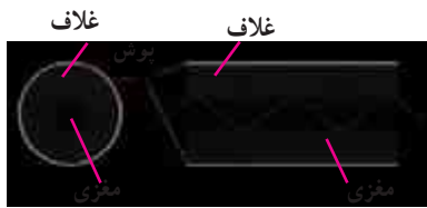
(الف) طرحی از ساختار یک تار نوری و مسیر زیگزاگی که نور در آن می‌پیماید.
