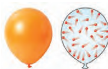
شکل ۲-۶ حرکت نامنظم ذرات گاز درون یک بادکنک
